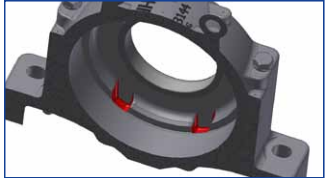
Zusätzliche Taschen ermöglichen die Verbindung der beiden Lagerseiten bei Ölschmierung
