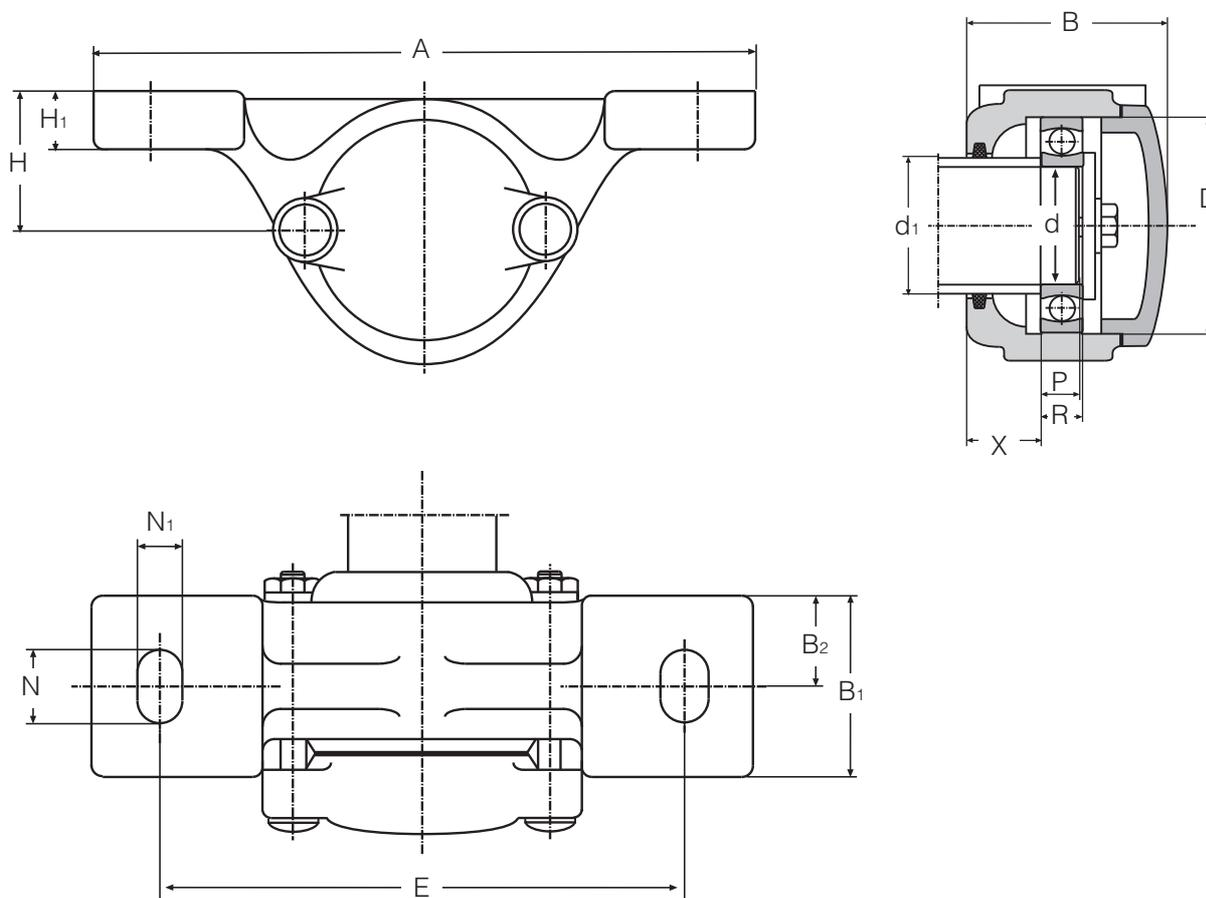
Este tipo de soporte puede emplearse a una temperatura de hasta 200 C. Está equipado con juntas de grafito que lleva un polvo lubricante especial para altas temperaturas. Asimismo, el rodamiento a montar también debe ser especial para altas temperaturas. (Rodamiento no incluido en el suministro)
