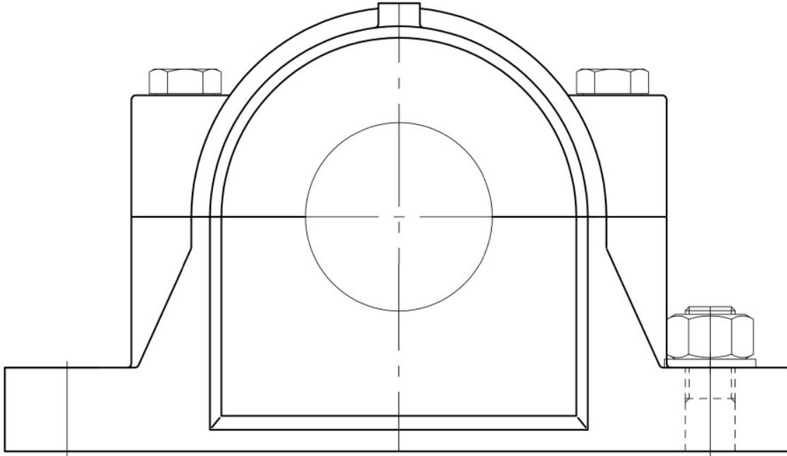
La livraison se fait en série sans trou de fixation. Sur demande deux ou quatre trous conformes au tableau dimensionnel peuvent être livrés. Fonte GGG40+GS 45.
