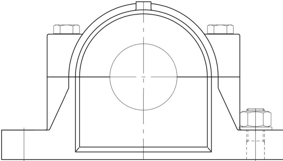
Die Lieferung erfolgt standardmäßig ohne Fußlochbohrungen. Auf Wunsch werden wahlweise zwei oder vier Anschraublöcher gemäß Maßtabelle angebracht. Werkstoff GGG 40 + GS 45
