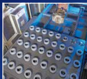
Produzione di qualità 24 ore su 24: robot ad elevate prestazioni caricano il centro di lavoro CNC con parti in serie su larga scala
