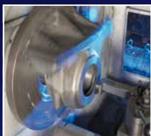
Lavorazione di un supporto su un centro di tornitura CNC
