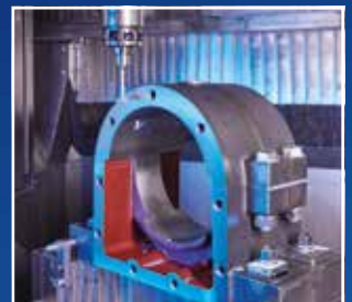
Fabrication ultra moderne sur centre d'usinage à 5 axes
