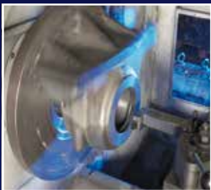
Mecanizado de una carcasa en un centro de mecanizado CNC
