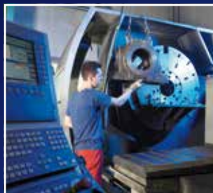
Experiencia en la fabricación de carcasas de rodamientos grandes: componentes con pesos de más de 4 t se mecanizan con la más alta precisión.
