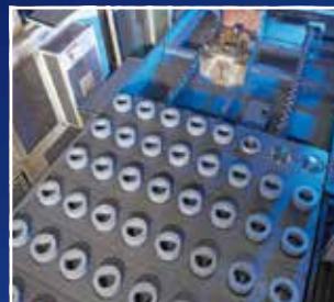
Producción de calidad „a todas horas“: robots de alto rendimiento cargan el centro de mecanizado CNC con piezas de series a gran escala.
