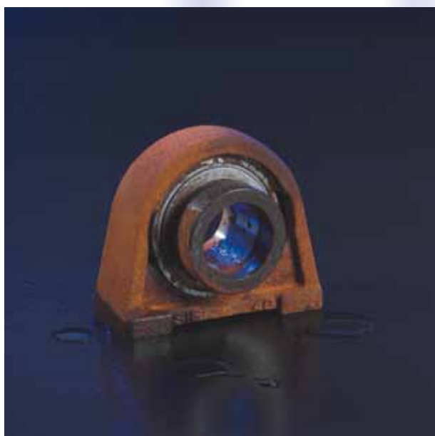
Carcasa de cojinete afectada por la corrosión
