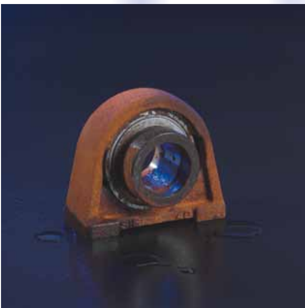
Palier attaqué par la corrosion
