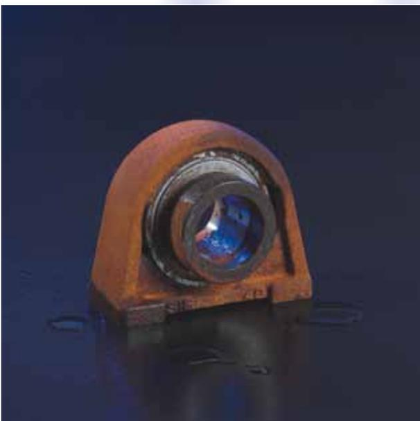
*Gehäuselagereinheit, die durch Korrosion angegriffen ist*
